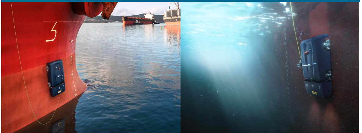
선체 부착물을 청소하는 로봇 헐스케이터(Hullskater)
